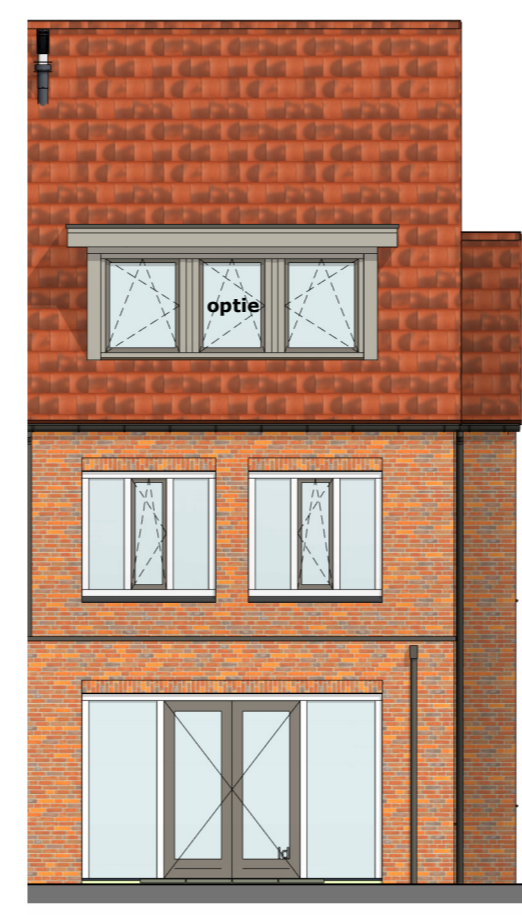
Als. get.: bwr. 11 (P6) achtergevel Opties: - Uitbouw begane grond 2400mm - Dakkapel achtergevel
